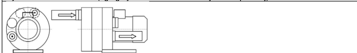
Rys. 4: 4RB 23 ... 4RB 63 (agregaty trójwirnikowe w wersji trójstopniowej)
